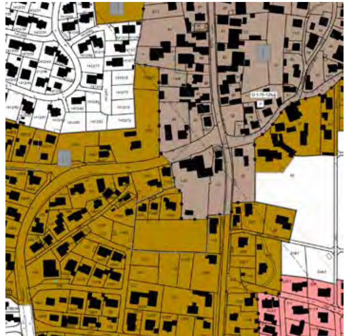
Abb. 25: Beispiel für einfachen Bebauungsplan zur Steuerung des Maßes der Nutzung im Innenbereich über Festlegung von Quartierstypen (Ausschnitt), Gemeinde Denkendorf (Landkreis Eichstätt)
