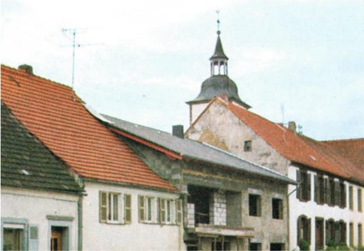
*Der Neubau fügt sich mit seiner flachen Dachneigung nicht in die Häuserzeile mit Steildächern ein und zerreit damit das ganze Ensemble; dunkles, untypisches Dachdeckmaterial, zu groe Trauf- und Ortgang-berstnde, querrrechteckige Fensterformate und der Balkon machen das Haus insgesamt zum Fremdkrper.*
